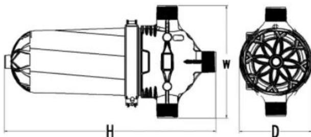
Esquema de dimensiones y conexión de modelo F63TS
