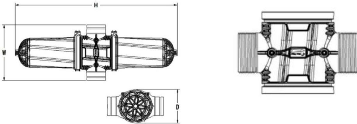
Esquema de dimensiones y conexión de modelos F90HS y F110HSL
