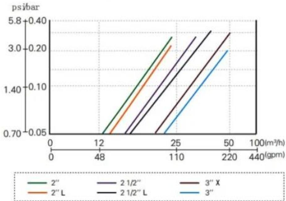
Perdidas de carga para modelo F63TS (120 Mesh)
