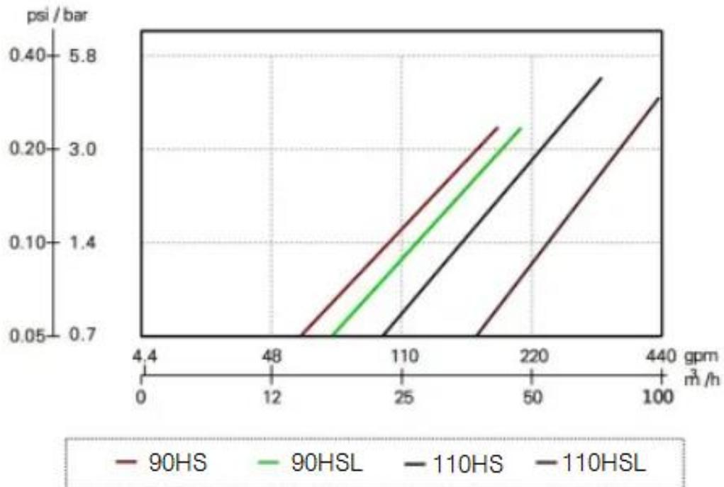
Perdidas de carga para modelos F90HS y F110HSL (120 Mesh)
